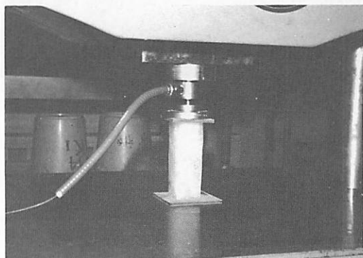
写真-3 一軸圧縮強度実験
