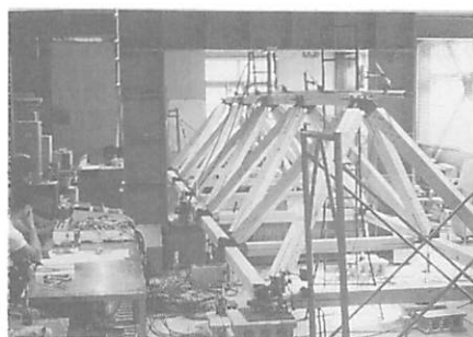
図-14 トラス梁の加力実験
